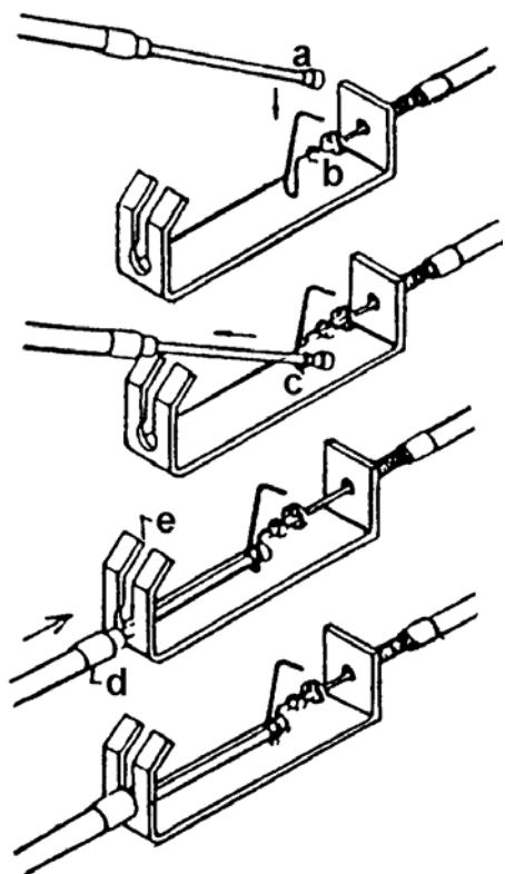
1. Извлеките кабель натяжения из опорной стойки поручней. Убедитесь, что рукоятка регулировки натяжения находится в положении 1 (минимальное значение).
