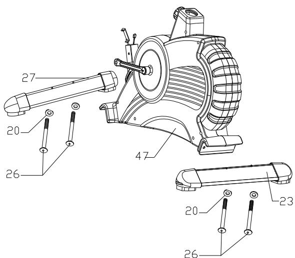
1. Присоедините передний стабилизатор (27) к основной раме (47) при помощи 2 винтов M8 (26) и 2 плоских шайб (20).
