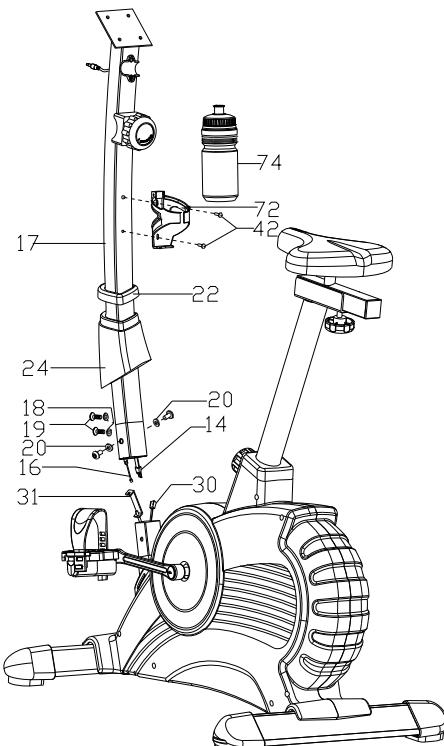
1. Соедините кабели компьютера (30) между основной рамой и опорной стойкой поручней как это показано на рисунке слева.
