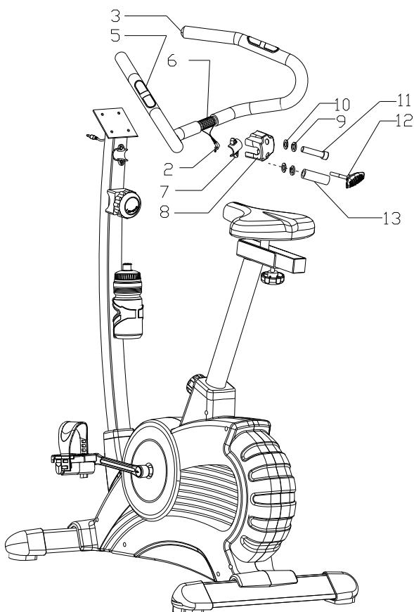
1. Установите поручень (6) в паз опорной стойки поручней при помощи металлической крышки (7), пружинной шайбы, шайбы и винта (11).
