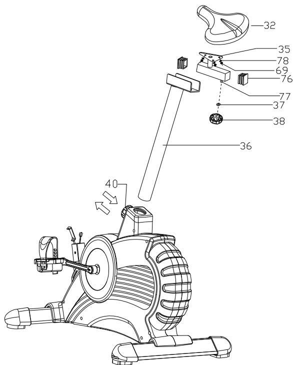
1. Установите сидение (32) на ползунок (35), используя 3 винта и 2 плоские шайбы. Затем установите винт и крепко затяните. Закрепите ползунок (35) на стойке сидения (36) с помощью регулятора (38) и плоской шайбы (37).
