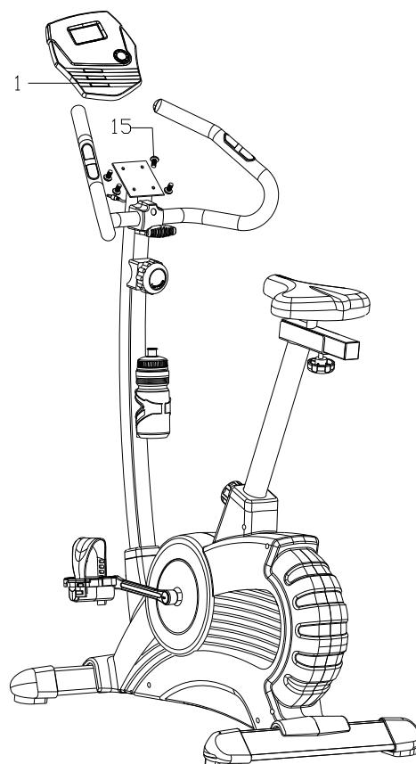
1. Установите компьютер в паз, закрепив 3 винтами (15).
